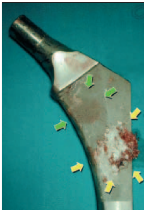
Figura 11. Stelo di protesi non cementata a cuneo in titanio con trattamento di superficie del titanio per aumentarne la rugosità nella regione metafisaria. Lo stelo è stato rimosso per una mobilizzazione asettica. Si può osservare come l'osteointegrazione nella regione trattata sia stata minima (zone delimitate delle frecce). Anche negli impianti osteointegrati è difficile trovare percentuali di osteointegrazione superiori al 50%.
